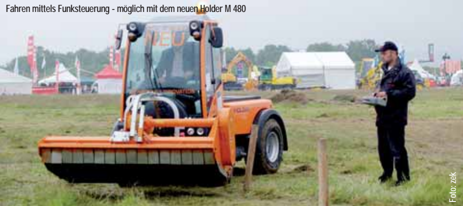
Fahren mittels Funksteuerung - möglich mit dem neuen Holder M 480
